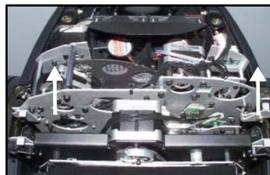
Bild 14: Modul entriegeln und entfernen
