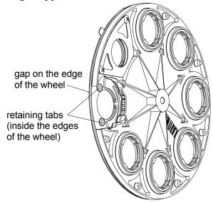
Figure 7-15. Replacing a static litho.
